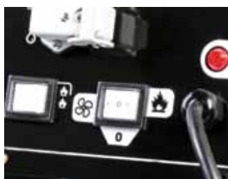
Consente due differenti potenze termiche: 80 kW and 110 kW
